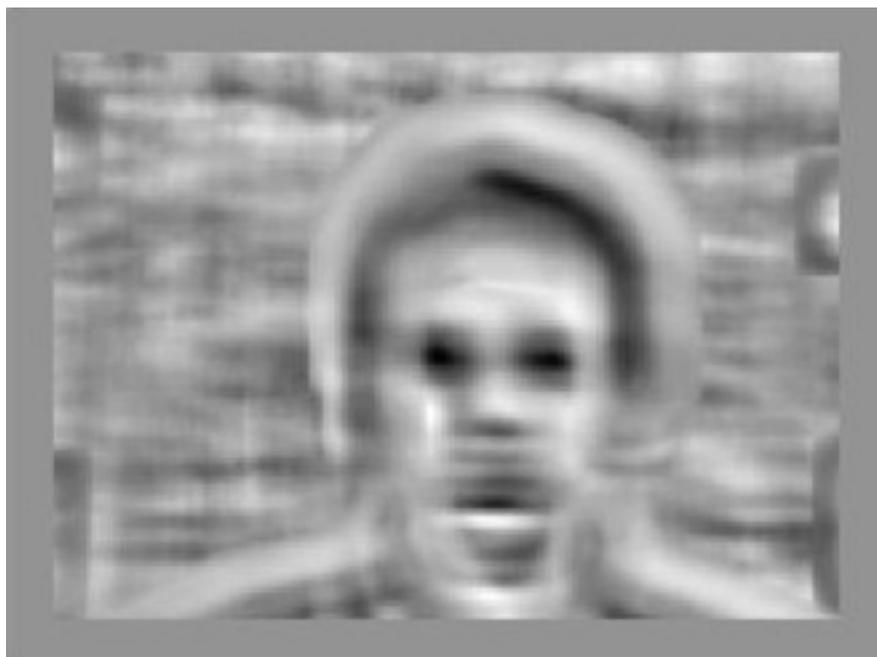
Obr. 2. Korelační koeficient mezi daným obrazem a šablonou pro pravé oko. Oblasti v obraze s velkou hodnotou korelačního koeficientu jsou zobrazeny černě.
